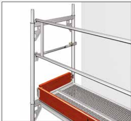
Uso del marco de 1,00 m. como lateral de coronación.
