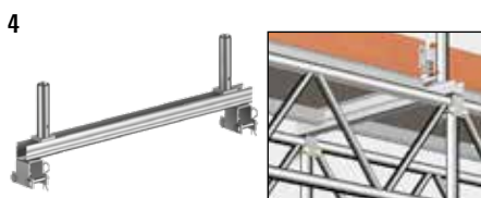
En usos de pórticos con vigas de celosía cabe la posibilidad de seguir montando con marcos de 0,73 m. de ancho en las dimensiones del sistema.
