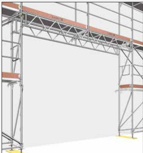
Ejemplo: viga de celosía Blitz de 5,14 m. y andamio revestido (diagonalización especial).
