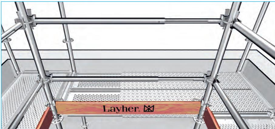
La plataforma de aluminio extensible para "U" se utiliza en huecos que tienen una longitud entre 1,57 y 2,57 m.
