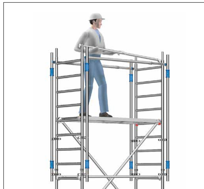
Fig. 6: Colocación segura de las barandillas con AGS
