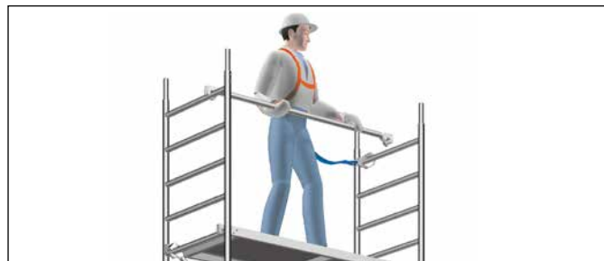
Fig. 3: Colocación de las barandillas con EPI
