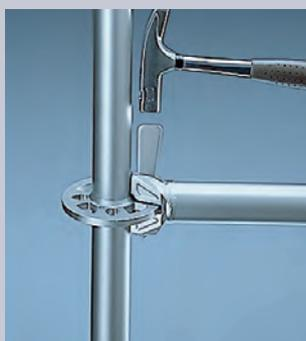
A golpe de martillo la conexión suelta se convierte en una unión estructuralmente rígida y resistente. El extremo de la cabeza del horizontal Allround queda posicionado con precisión contra la superficie del vertical.
