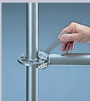
**El sistema Allround utiliza una tecnología de conexión sin tornillos única y simple.** Se desliza la cabeza con cuña Allround sobre una roseta, insertamos la cuña en una de las aberturas que posee la roseta e inmediatamente queda fijada la horizontal, manteniendo aún holgura suficiente para asegurar el otro extremo de la horizontal.
