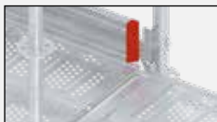
Montaje de rodapié de acero.
