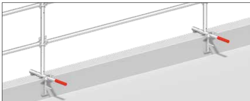
Ejemplo de aplicación de la mordaza para forjados en petos.
