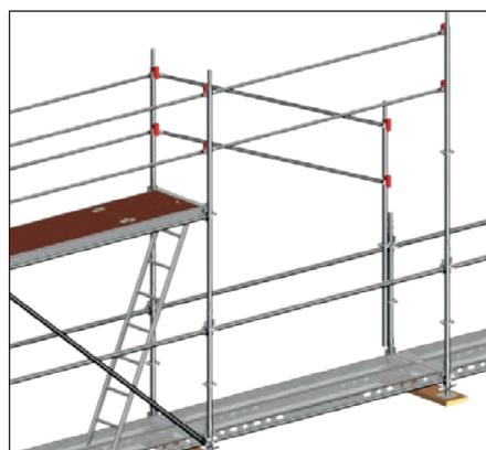
El vertical AGS permite el montaje de barandillas tanto en el exterior del andamio como en ambos lados. En este caso, comenzar con un vertical de 1,00 m. en ambos lados. El montaje adicional como la variante 1.
