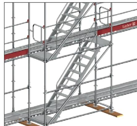
El sistema AGS también puede ser utilizado en el montaje de una torre de escalera exterior.
